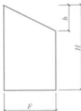
图 C.0.5 混凝土侧压力计算分布图
